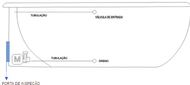
As tubulações da válvula de entrada e dreno, serão direcionadas de fábrica, para onde fica o motor e a tampa de inspeção.
