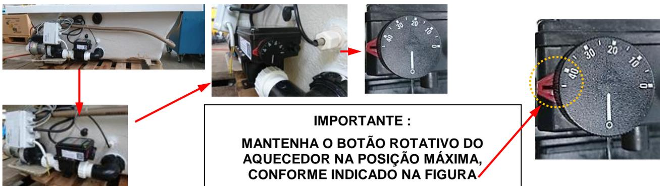
Após instalação, manutenção ou outro eventual manuseio na parte inferior interna da banheira, recomendamos sempre observar se este botão encontra-se nesta posição, reajustando-o manualmente para a posição máxima original de fábrica conforme figura acima, caso necessário.
