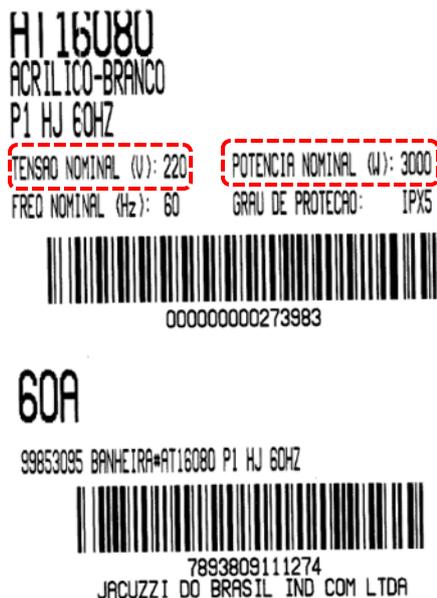
A fiação da rede de suprimento de energia elétrica e dispositivos de interrupção e proteção contra sobrecargas e choques elétricos obrigatórios para a banheira, deverão estar em conformidade com requisitos da norma ABNT NBR 5410 e especificações da tabela abaixo
