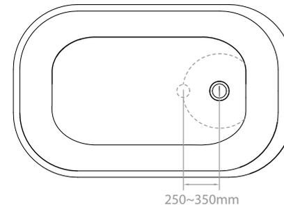
**3.** Suspenda a sua banheira no local onde ela será posicionada e conecte o sifão na saída de água do piso;
