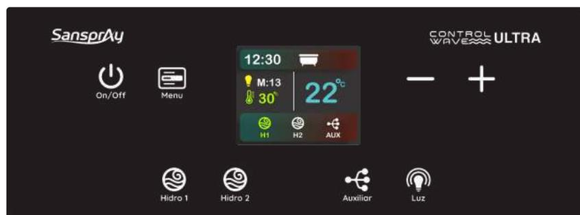
Caso alguma tecla de acionamento de alguma saída ou a temperatura programada seja alterada, Modo eco é desabilitado automaticamente, mudando o indicador de temperatura programada para vermelho.
