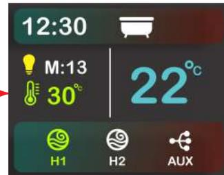
O modo eco é um modo econômico de aquecimento, onde a resistência e a motobomba Hidro 1 é desligada assim que a temperatura atual da água atinge a temperatura programada.
