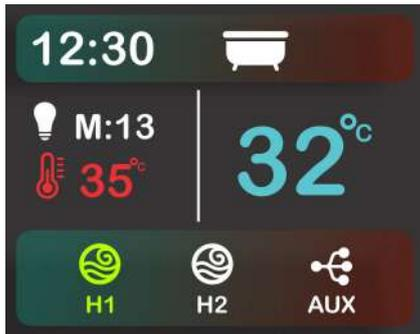
A circulação de água no bojo é essencial para o sistema de aquecimento, desta maneira, o sistema não permite que a resistência seja ligada a menos que a motobomba da saída Hidro 1 esteja ligada e que haja água no sistema.
