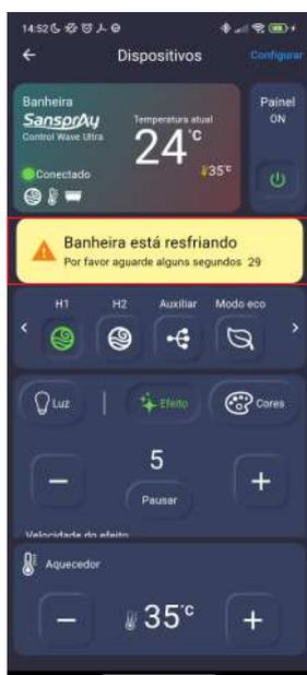
Caso a motobomba Hidro 1 seja desligada durante o aquecimento, ou o Painel seja desligado, o sistema entrará em modo de resfriamento por 30 segundos, mantendo a Hidro 1 ligada.
