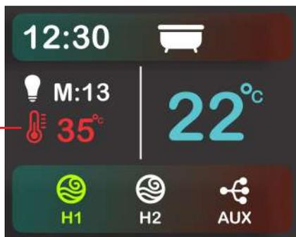
Quando a temperatura programada é maior que a temperatura atual, o termômetro e o valor da temperatura programada ficam vermelhos, indicando que o sistema de aquecimento está ativo.
