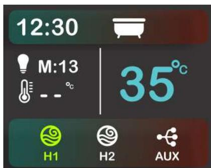
Para desligar o sistema de controle da temperatura, baixe a temperatura programada até aparecer --°C no display. Desta maneira, mesmo que a temperatura atual da água fique menor que 20°C, o sistema de aquecimento não será ativado.
