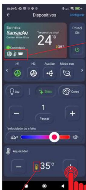
Os ícones da Hidro, Aquecimento e Nível de água aparecem no aplicativo. Caso o ícone de Aquecimento não esteja aparecendo, indica que o sistema de controle de temperatura não está ativo. Para ativar, mude o valor da temperatura programada
