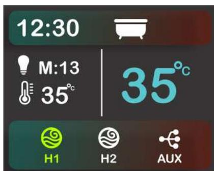
Quando a temperatura atual da água atinge a temperatura programada, o sistema de aquecimento é desligado. O termômetro e o valor da temperatura programada ficam brancos. Quando a temperatura programada ficar 1°C abaixo da temperatura atual, o sistema de aquecimento liga novamente, até atingir a temperatura programada e desligar.
