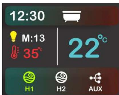
Diferente do Modo Eco, quando em aquecimento normal, ao atingir a temperatura programada, apenas a resistência é desligada, mantendo a motobomba Hidro 1 ligada.
