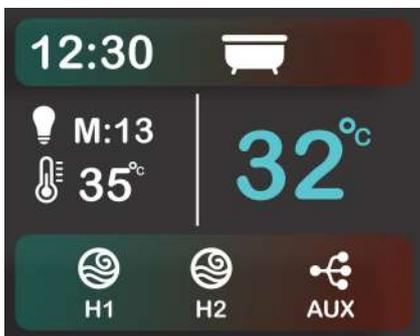
Para retomar o aquecimento, é necessário ligar novamente a Hidro 1 e ajustar novamente a temperatura programada. Como o sistema de aquecimento foi anteriormente interrompido, mesmo que apareça uma temperatura programada maior que a temperatura atual, é necessário que o usuário modifique a temperatura programada utilizando as teclas +/- para que o sistema entenda que o usuário quer retomar com o aquecimento.
