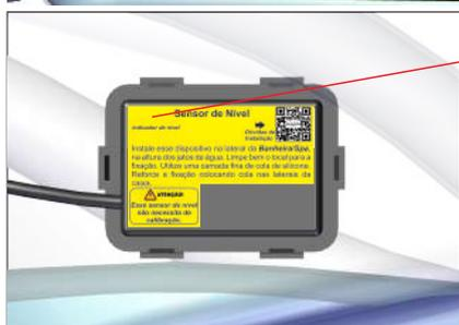
Led apagado indica falta de detecção de água
