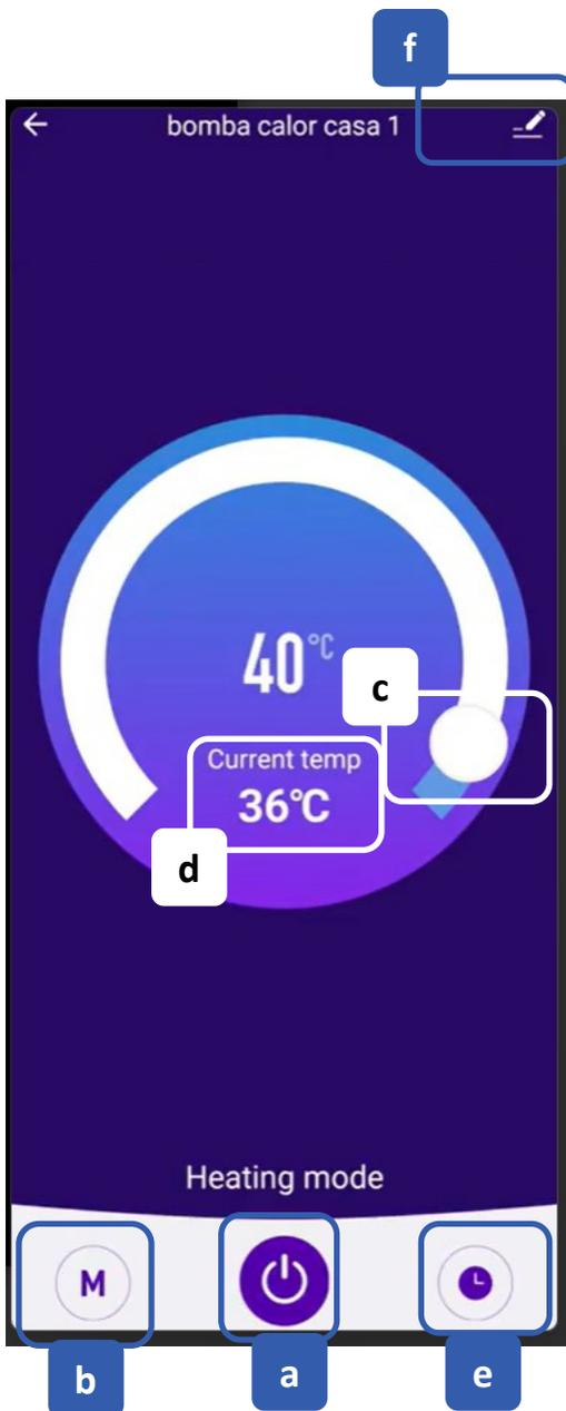
a - Liga e desliga a bomba de calor FTi;
