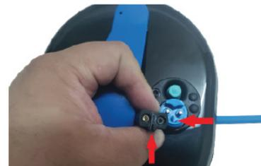
7. Insira o cabo de carregamento na bateria. Se o cabo não for inserido na direção correta, conforme indicado pelo entalhe e pelo slot, você poderá danificar o robô, a bateria ou o carregador.
