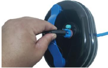
8. Ao carregar a bateria, uma luz LED no carregador acende. Uma luz vermelha indica que a bateria está carregando. Uma luz verde indicará uma bateria totalmente carregada.
