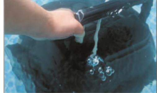
11. Pressione o botão na parte superior da bateria. Uma luz LED ao lado do botão acenderá. O robô então executará seu ciclo de limpeza de 1,5 horas e, em seguida, desligará automaticamente. Se quiser desligar o robô mais cedo, mantenha o botão pressionado.
