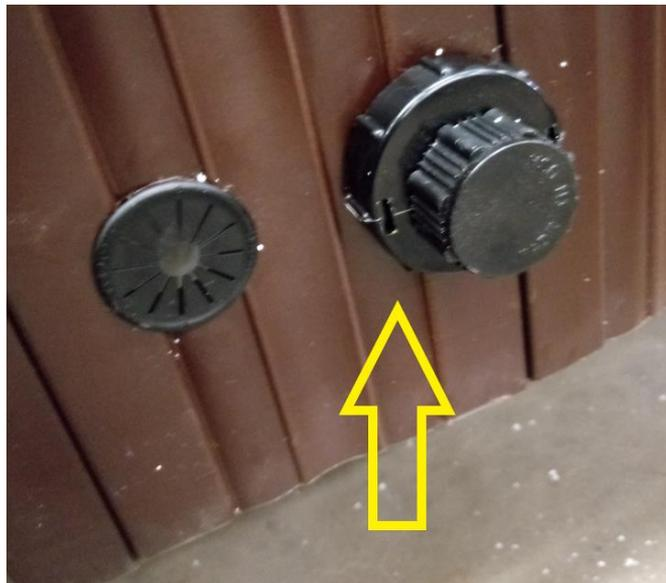
Passe a mangueira através da furação do isopor e conecte-a na válvula que esta acoplada ao painel de fechamento. Não esqueça de colocar a braçadeira antes de fazer a conexão.
