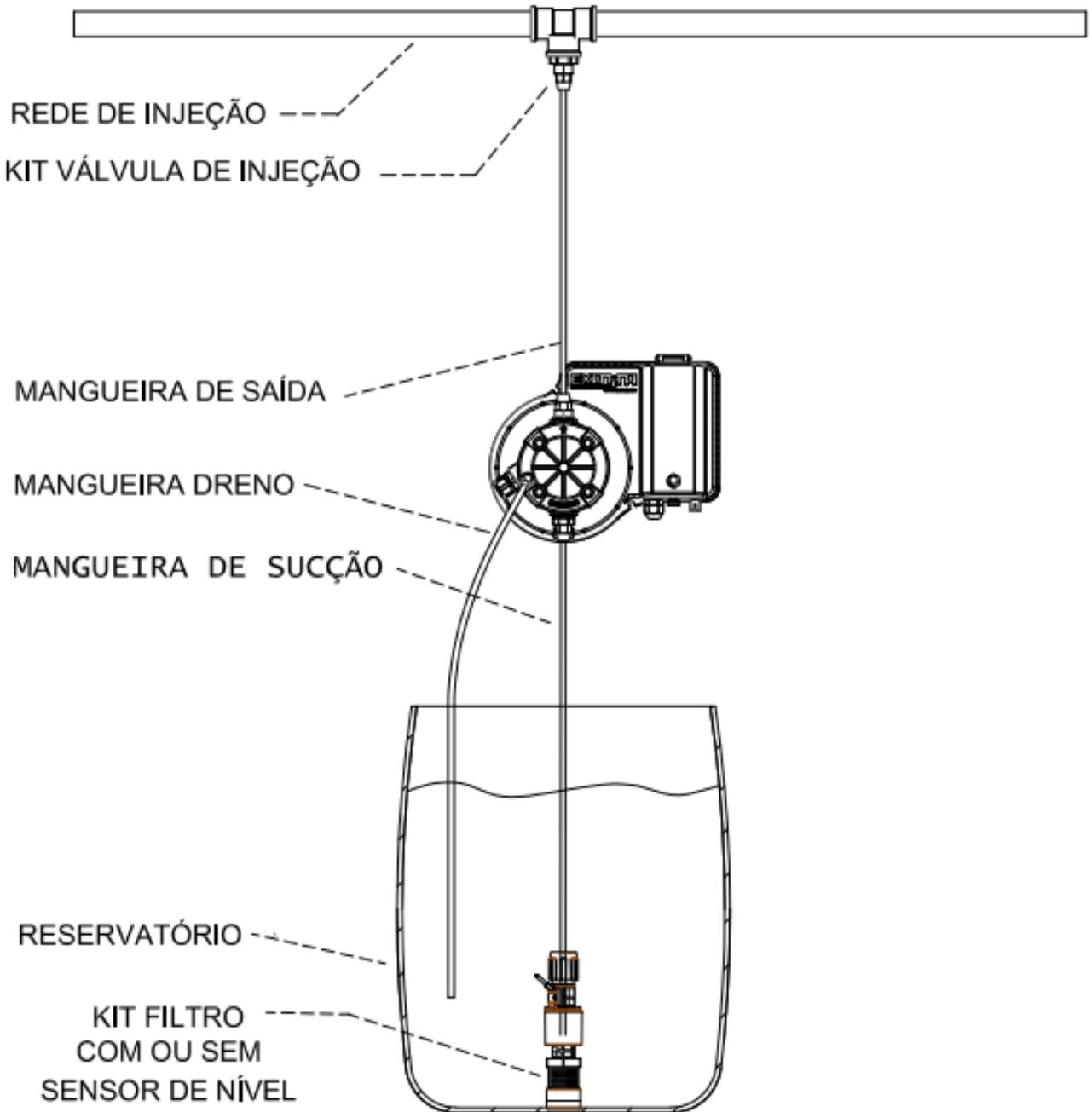
A bomba deve ser fixada na parede ou em qualquer outro suporte, desde que seu ângulo não ultrapasse os 45° da vertical conforme Figura 3.
