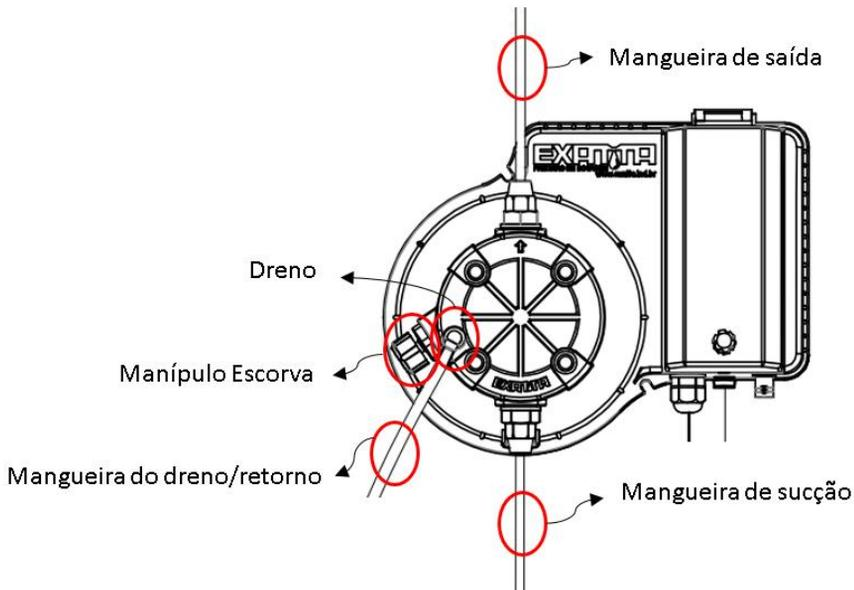
**Figura 6: Conexão da válvula de injeção.**
