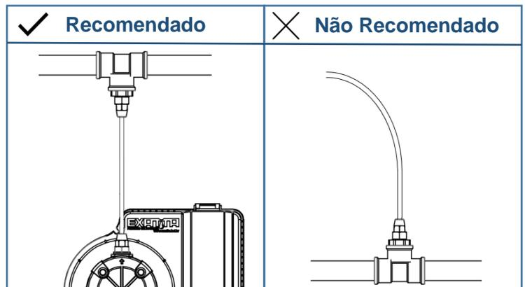
**Nota:** É recomendado que a válvula de injeção fique na posição vertical com a dosagem para cima para facilitar a saída de gases presentes na parte hidráulica.
