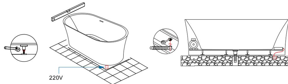
6. Coloque um pouco de água na banheira ainda elevada para verificar se há algum vazamento, e teste o sistema.
