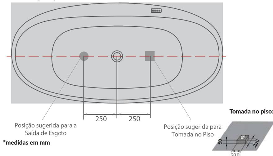
4. Coloque a banheira elevada acima do local da instalação por intermédio de banquinho ou cadeira (por exemplo), conecte os fios na rede elétrica e o flexível na saída do esgoto.
